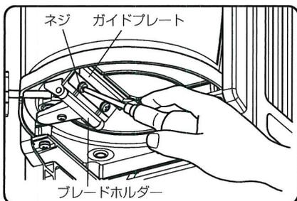
5 刃物固定ネジ(2本)を⊕ドライバーで少しゆるめてください。この時ネジは完全に取り外さないでください。
