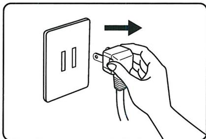
1 電源スイッチをOFF(切)にし、コンセントから電源プラグを抜いてください。
