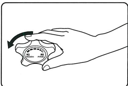
4 刃物調節ツマミを左に回して刃先が切削台の平らな面より出るようにしてください。
