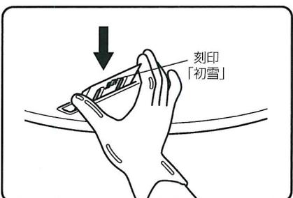
7 新しい刃物の刻印「初雪」がガイドプレート側になるようにして、氷削台の上からブレードホルダーとガイドプレート間に差込んでください。
