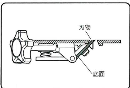
8 刃物の底面をブレードホルダーに当て刃物固定ネジで固定します。
