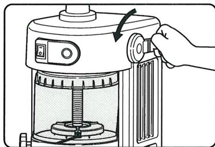
**5** 氷押えは、上下ハンドルを反時計方向に回して下げてください。
